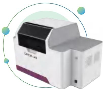
细胞检测与分离挑选系统 (Droplet Entrapping Microfluidic Cell-sorter, DREM cell) 是基于液滴微流控技术开发而成的超高通量单细胞分选平台。它每秒可以发生成千上万的微液滴 (pL)，细胞包裹于微液滴之中，可进行生长、裂解、代谢、反应等生物生化过程，并与液滴之中的荧光筛子进行充分结合，产生不同强度的荧光信号；之后利用微液滴分选技术将低产出和高产出的细胞通过荧光信号分选出来，实现分选过程的高通量化。
